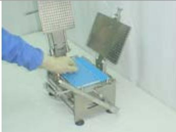
19. Coloque la Placa de tapas con la Placa de empuje sobre el Llenador. Deslice la Placa de empuje hacia afuera.
