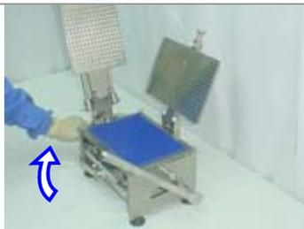
11. Suelte la Palanca. Esto permite que los cuerpos de las cápsulas caigan de modo que los extremos abiertos estén a nivel con la superficie superior del Llenador.
