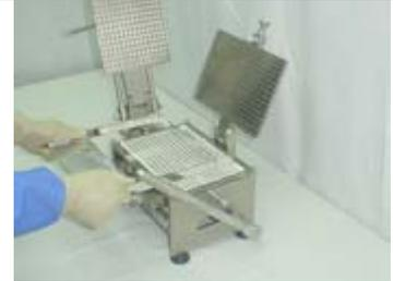
18. Levante el Compactador y esparza el polvo restante dentro de los cuerpos de las cápsulas. Retire la Placa de polvo.
