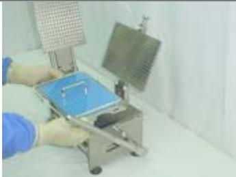
7. Coloque la Placa de tapas sobre el Llenador.
