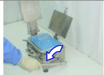
9. Presione sobre la palanca de elevación para separar las tapas de las cápsulas de los cuerpos.
