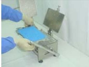
23. Retire la Placa de tapas y tendrá 300 cápsulas llenas, cerradas.
