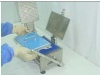
10. Levante y deje a un lado la Placa de tapas que contiene las tapas de las cápsulas.
