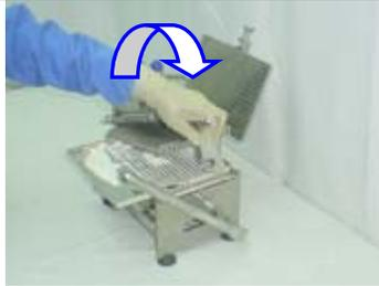
14. Baje el Compactador de bloqueo automático. El compactado le permite llenar las cápsulas con más polvo y obtener pesos de llenado más uniformes.
