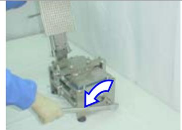
21. Presione la palanca de elevación para cerrar las cápsulas en su totalidad en un solo paso.
