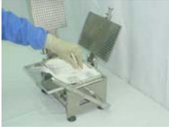
13. Coloque el polvo previamente medido en el Llenador. Use el Esparcidor de Polvo para llenar los cuerpos de las cápsulas.
