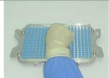
6. Quite el Orientador y use la Placa de empuje para asentar bien las cápsulas dentro de la Placa de tapas.
