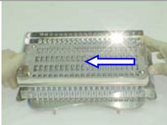
4. Empuje la parte deslizante del Orientador para que libere las cápsulas dentro de la placa de tapas.
