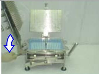
8. Tire de la palanca, ésta se eleva hacia usted para asegurar los cuerpos de las cápsulas en el Llenador.
