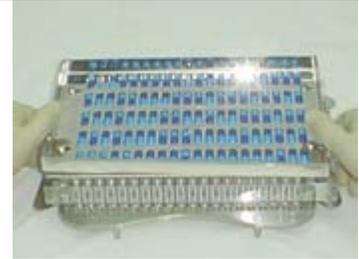
3. Coloque el Orientador sobre la Placa de tapas en la posición marcada como "I". Las guías de las espigas de la Placa de tapas facilitan esta acción.
